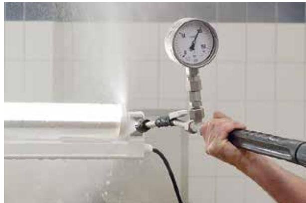
> Hochdruckreinigung des Gehäusedeckels mit 100 bar
