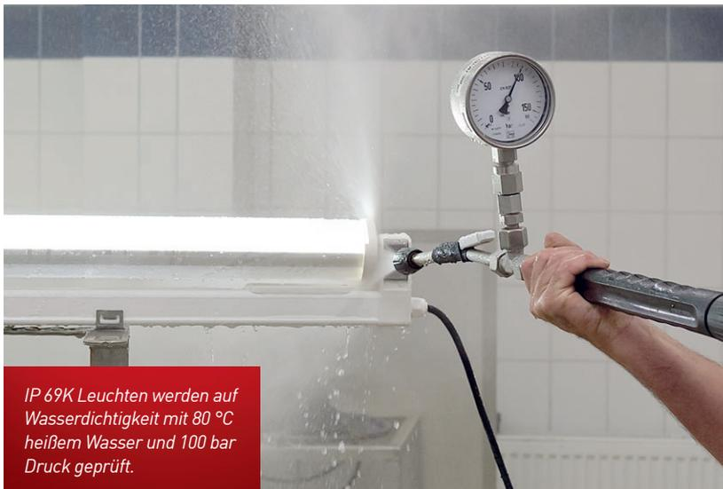
*IP 69K Leuchten werden auf Wasserdichtigkeit mit 80 °C heißem Wasser und 100 bar Druck geprüft.*
